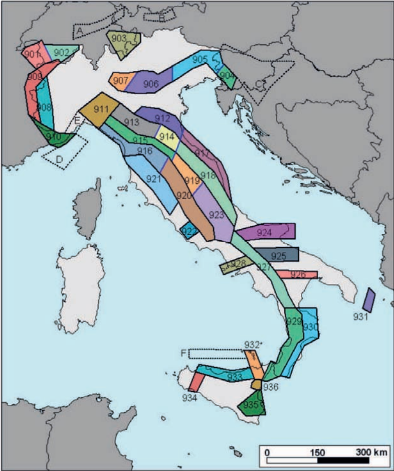
Figura 2 - Zonazione sismogenetica ZS9. Le diverse zone sono individuate da un numero; le zone indicate con una lettera non sono state utilizzate per la valutazione della pericolosità sismica. Il significato del colore (blu o nero) dei bordi delle zone è spiegato nel testo. Il colore delle zone non è invece significativo.
